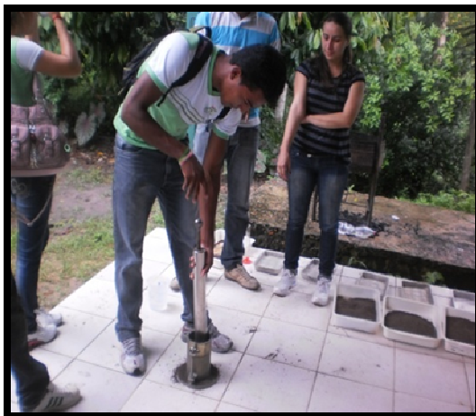
Figura 20: Teste de proctor Fonte: Roberto Dias
