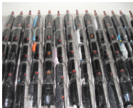
Figura 7 Colunas prontas para a montagem do coletor.
