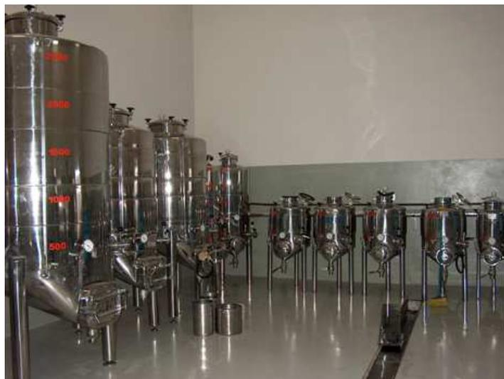
**Foto 4.** Dornas de fermentação da planta de processamento de vinho do IFSertão-PE.
