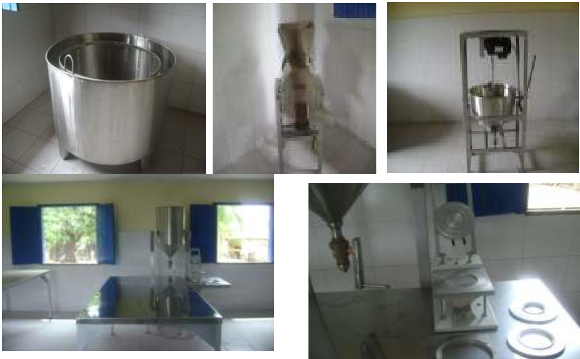
Anexo 10. Fotos dos equipamentos da unidade de Processamento de Frutas da comunidade do Quixoá. Pela ordem: Tanque de lavagem de frutas, Despoldadeira, Tacho de concentração, Dosador com mesa de inox recravadora de potes.
