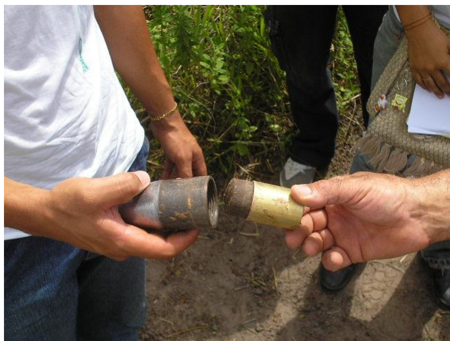
Foto 8: Amostra indeformada do solo para determinar a Densidade aparente na Unidade Demonstrativa do Projeto de Trabalho/Pesquisa, IFS/Campus São Cristóvão, 2008.
