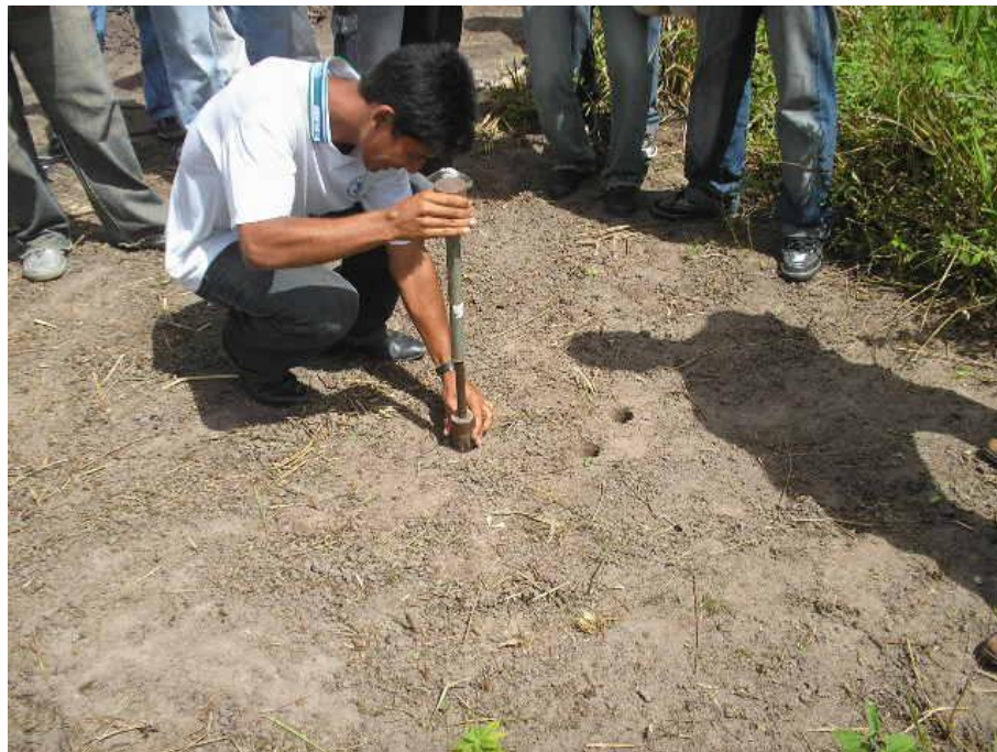
Foto 7: Alunos utilizando anéis de volume conhecido, retirando amostra indeformada para determinar Densidade aparente do solo, na Unidade Demonstrativa do Projeto de Trabalho/Pesquisa, IFS/Campus São Cristóvão, 2008.
