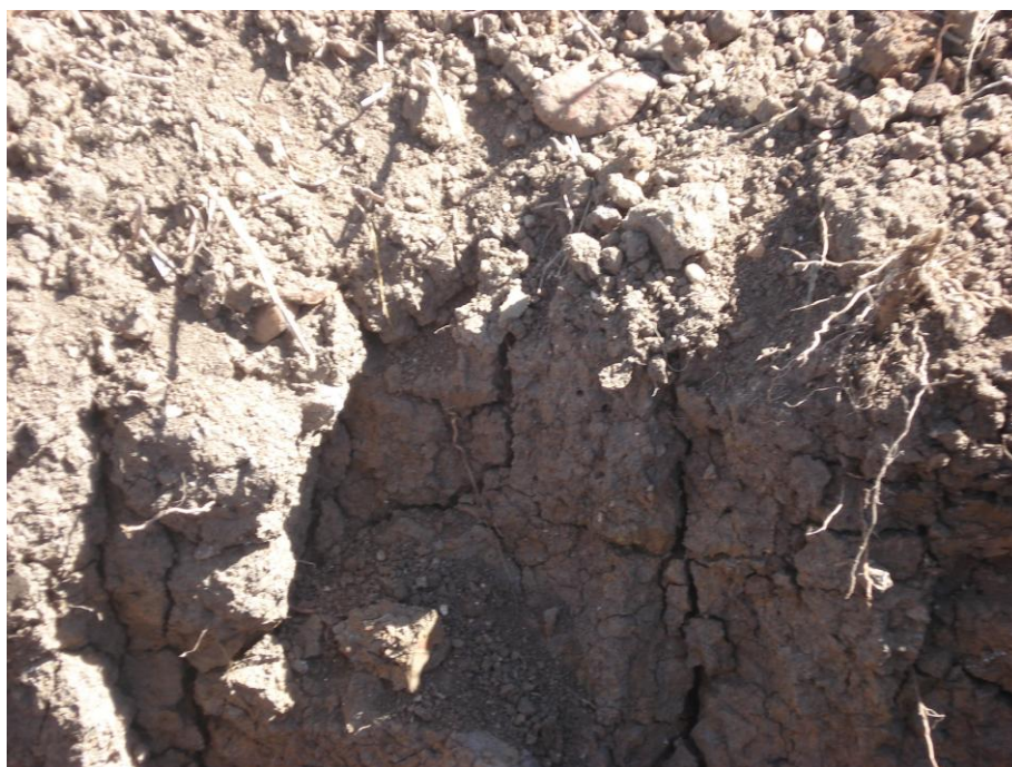
FOTO 1F 2 : Material do horizonte Ap descendo pelas fendas e colorindo as faces estruturais do horizonte Bi, Unidade Demonstrativa do Projeto de Trabalho/Pesquisa, IFS/Campus São Cristóvão, 2008.
