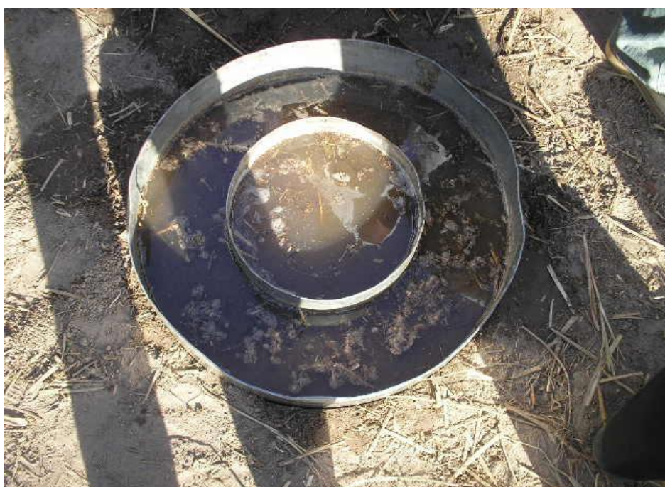
Foto 10: Anéis fixados concentricamente no solo para início do teste de velocidade de infiltração de água no solo da Unidade Demonstrativa do Projeto de Trabalho/Pesquisa, IFS/Campus São Cristóvão, 2008.
