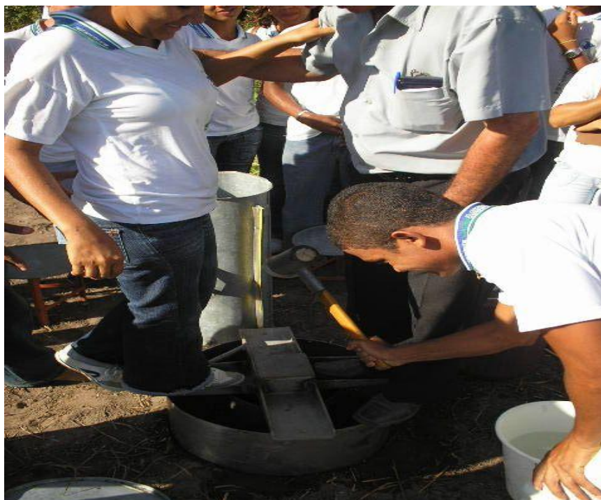
Foto 9: Fixação dos anéis volumétricos no solo para determinar a velocidade de infiltração no solo da Unidade Demonstrativa do Projeto de Trabalho/Pesquisa, IFS/Campus São Cristóvão, 2008.
