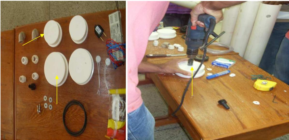
**Figura XIII** – Detalhe dos Caps de 100 mm Ø e 75 mm Ø e a direita a visualização da perfuração de um dos Caps de 75 mm Ø para passagem da fiação ligada ao reator permitindo a sua extensão aos fios condutores de energia elétrica.
