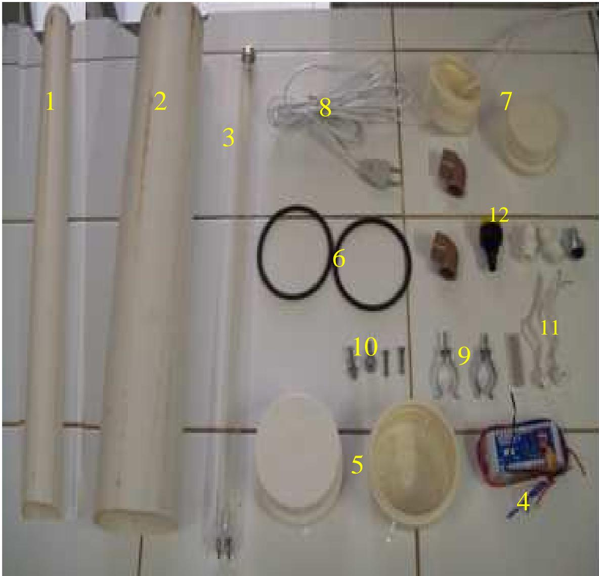
**Figura II** – Apresentação dos materiais básicos para construção do Tubo UV:
