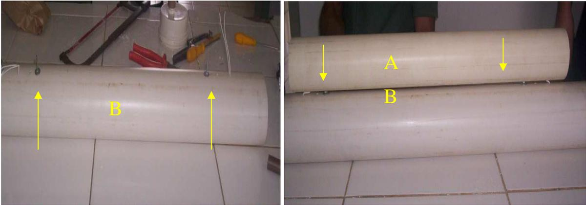
**Figura XI** - Fixação do tubo de 75 mm Ø ao tubo de 100 mm Ø destacando-se os parafusos visualizados na Figura IX. A esquerda visualiza-se (A) o tubo de 75 mm Ø e (B) o tubo de 100 mm Ø já acoplados.
