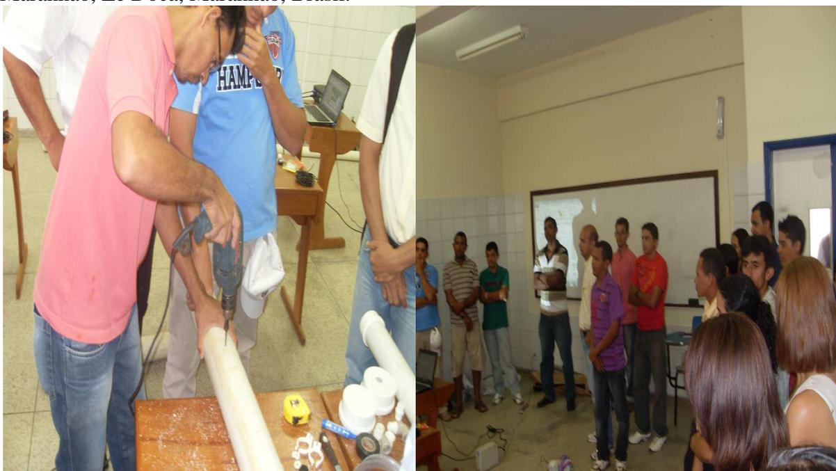
**Figura 36** – Imagens da 3ª Oficina de construção e adaptação do Tubo no momento em que um dos bolsistas, integrante da equipe de pesquisa realiza medição e perfuração dos orifícios necessários para junção do módulo receptor da lâmpada UV e do módulo receptor do reator usado para acionamento do equipamento. Ação realizada no Câmpus do Instituto Federal do Maranhão – Zé Doca, Maranhão, Brasil.
