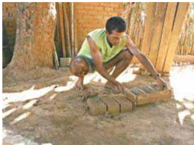
Figura 22 – Produção artesanal dos tijolos de adobe
