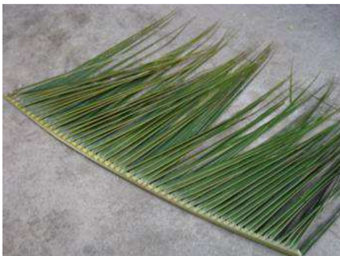
Figura 4 – Palha de coqueiro dobrada na forma de pente para cobertura de telhado. FONTE: Fotos do autor
