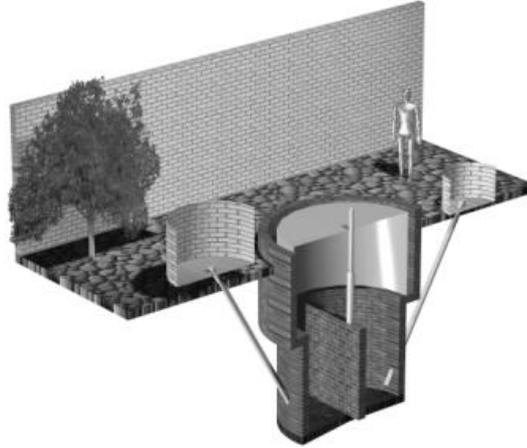
**Figura 9:** Representação tridimensional em corte do biodigestor modelo indiano
