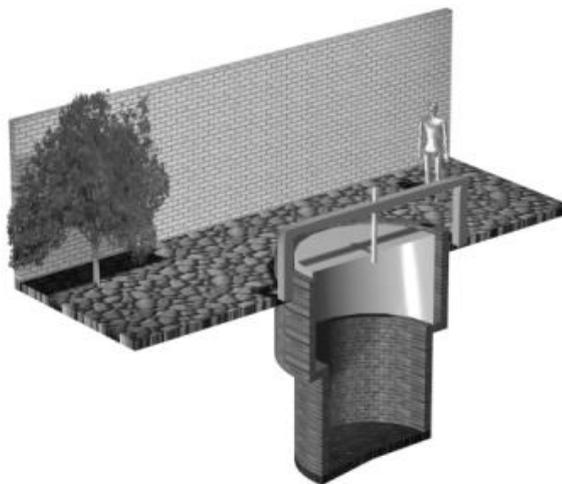
**Figura 13:** Representação tridimensional em corte do biodigestor modelo batelada.
