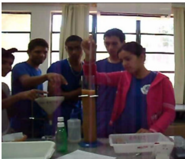
Figura 10 - Agitação das frações silte mais argila
