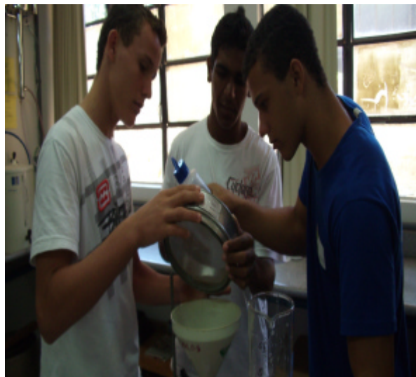
Figura 9 - Separação da fração areia
