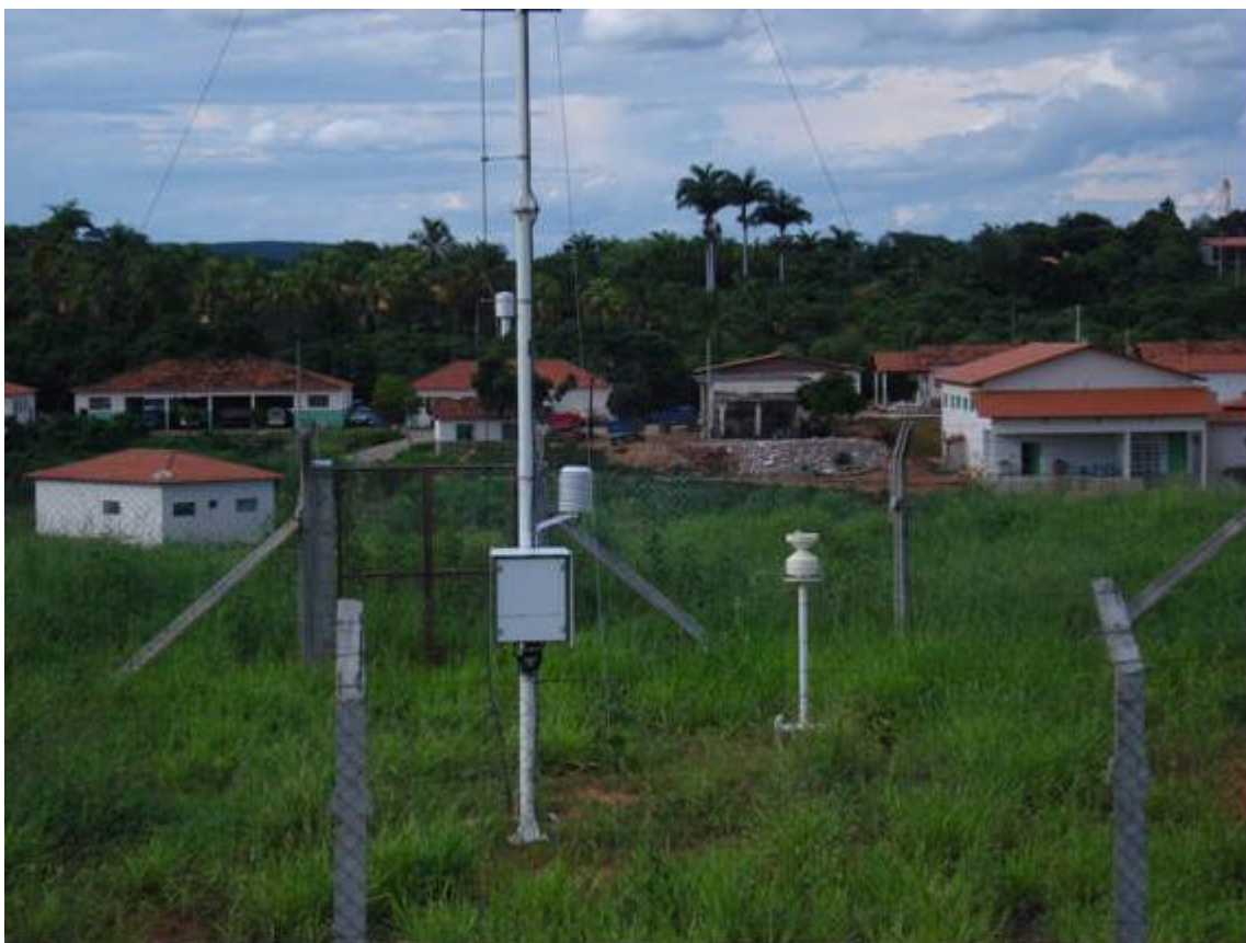
Figura 2 – Estação Climatológica Automatizada e vista parcial da EAF Salinas.
