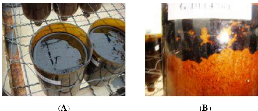
Figura 13. Vasos utilizados no experimento em casa de vegetação (vidros tipo âmbar) à esquerda (A), e detalhe da camada de cerca de 5 cm de óleo contaminante que se formou 15 dias antes do plantio sem percolar, à direita (B), para cultivo de girassol e mamoneira sob diferentes doses de torta de PDS.
