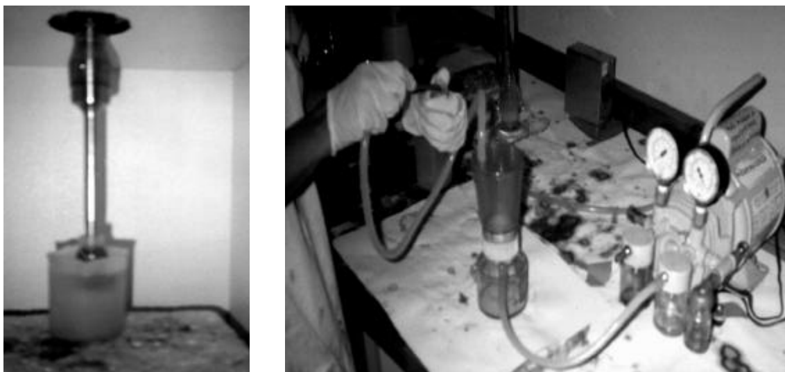
Figura 5. Detalhe da amostra no ultra-som (figura à esquerda). E, após a sonificação a fração orgânica sobrenadante é succionada por filtração a vácuo.
