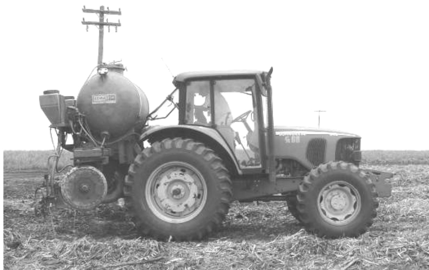
Figura 1. Conjunto trator e pulverizador utilizado para aplicação de nematicida e inseticida em soqueira adaptado para aplicação do inoculante em cana-soca.
