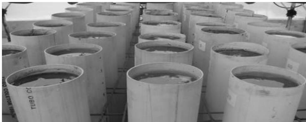
**Figura 12.** Simulação da precipitação, com uso de H<sub>2</sub>O destilada.
